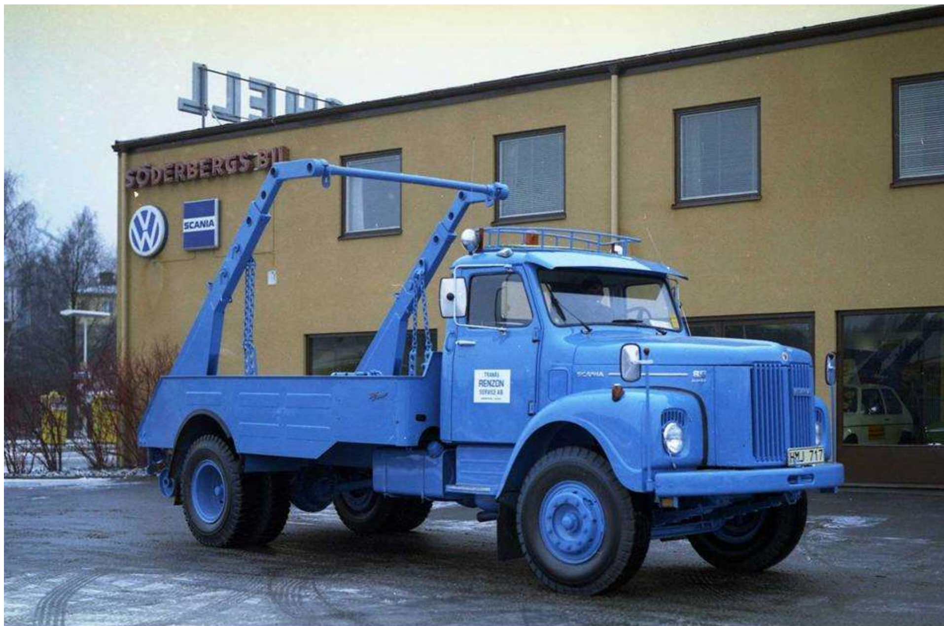
Scaniabil specialbygd för lyft och transport av sopcontainer. Levererades till Renzon i Tranås 1975
