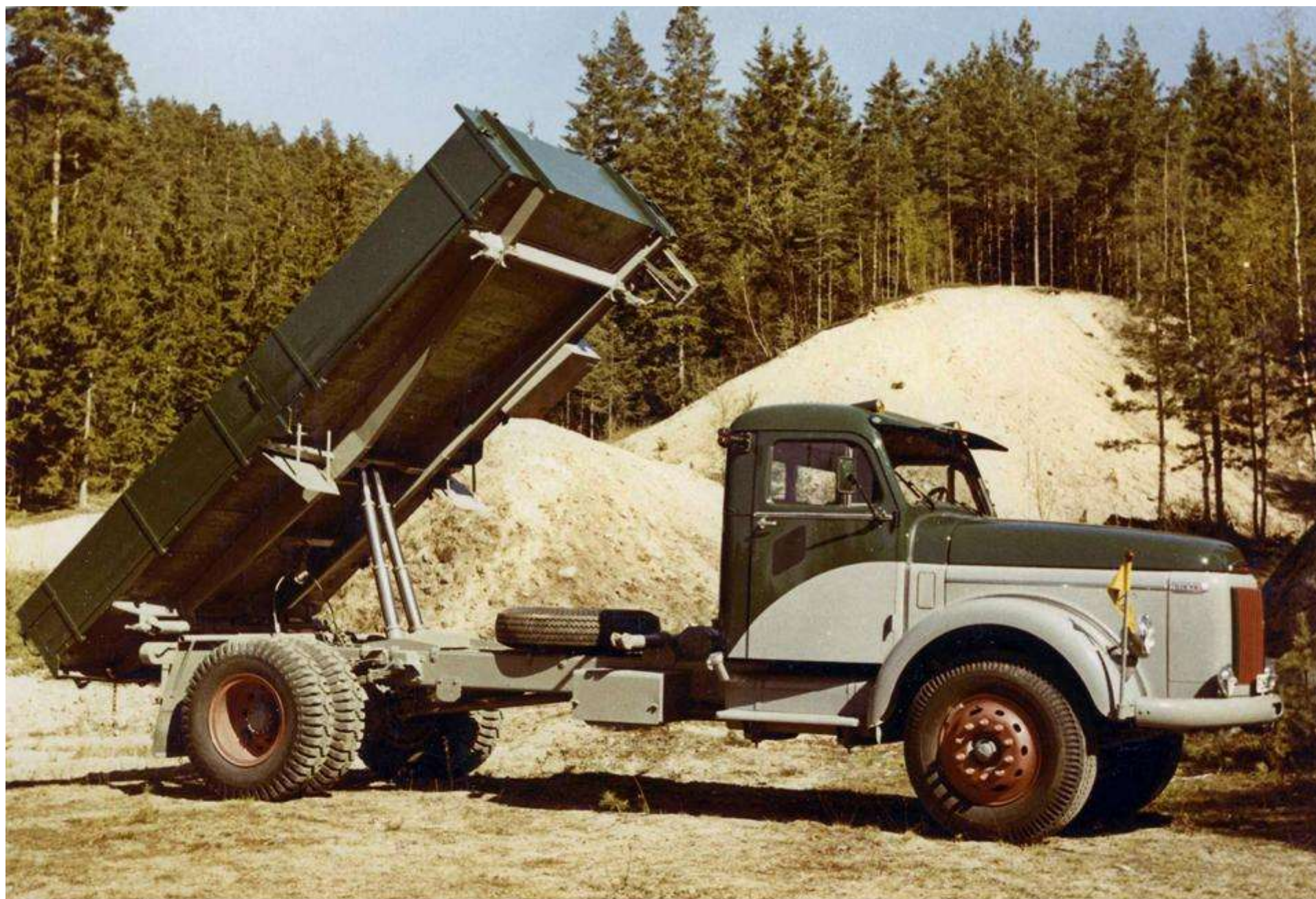
En Volvo från AM:s Bil AB med en hydraulisk tippanordning, troligen tillverkad och monterad på Tranåsverken. Tranåstippen togs fram i samarbete med Volvo under 1960-talet
