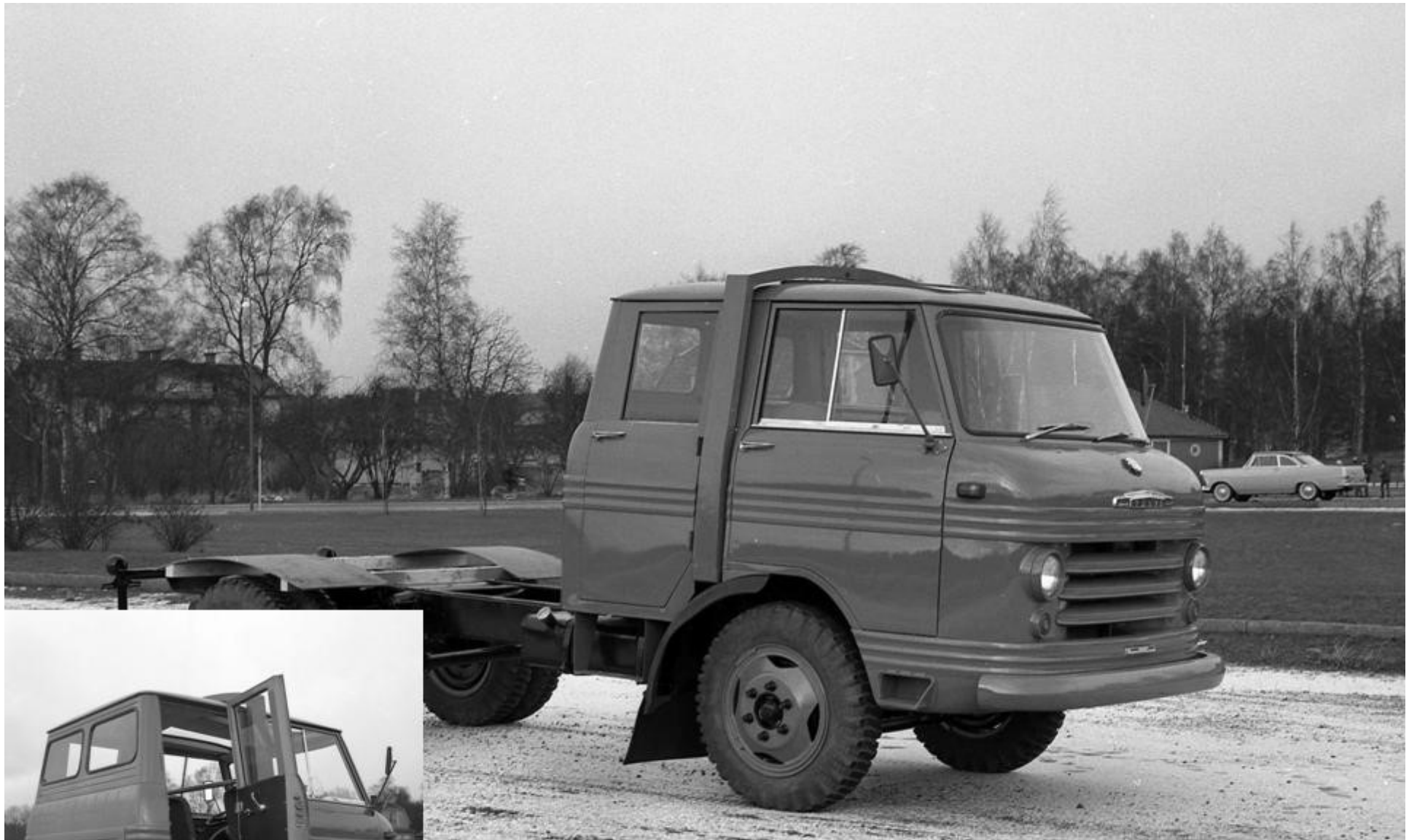
En Volvo med dubbelhytt, för att ge plats med ett passageraresäte bakom förarplatsen. Tillverkad av Vagnfabriken, dec. 1965. Foto utanför Parkhallen
