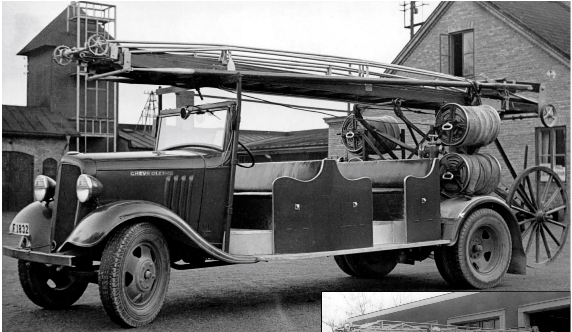
Fjärde utryckningsbilen, Chevrolet lastbil, reg. nr. F 1832. Köptes år 1938. På vilken – efter ombyggnad, fanns en 15 meters avbröstbar A-B-A stege
